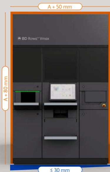
La base del sistema puede compensar desniveles en el suelo de 30 mm. Los desniveles más grandes deben ser nivelados in situ.
